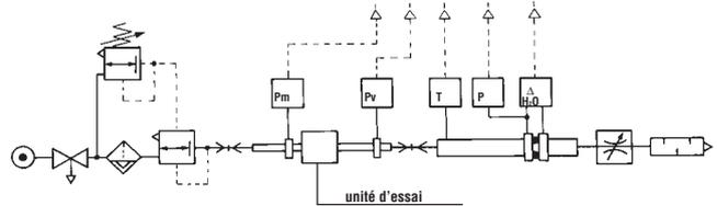
• Tests de débit effectués par le Département de Mécanique de l'Ecole Polytechnique de l'Université de Turin en utilisant le banc de mesure avec ordinateur et en suivant les indications de la recommandation CETOP RP50R (acceptée par l'ISO DIS 6358-2) avec mètreur à diaphragme ISO 5167.
